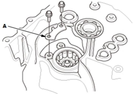
2. 使用可调轴承拆卸工具组件拆下滚针轴承 (A)。
